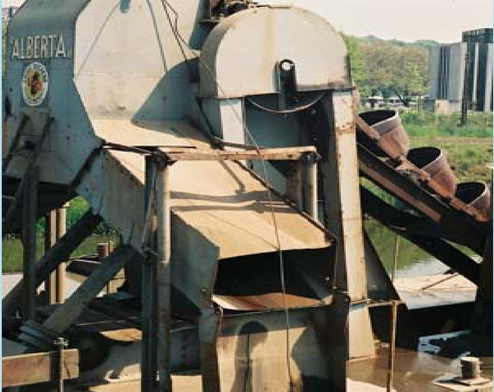
Une vue du déversoir de chargement des chalands
