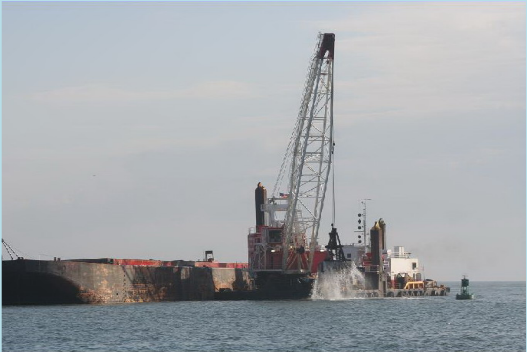
Vue d'une drague moderne à benne
