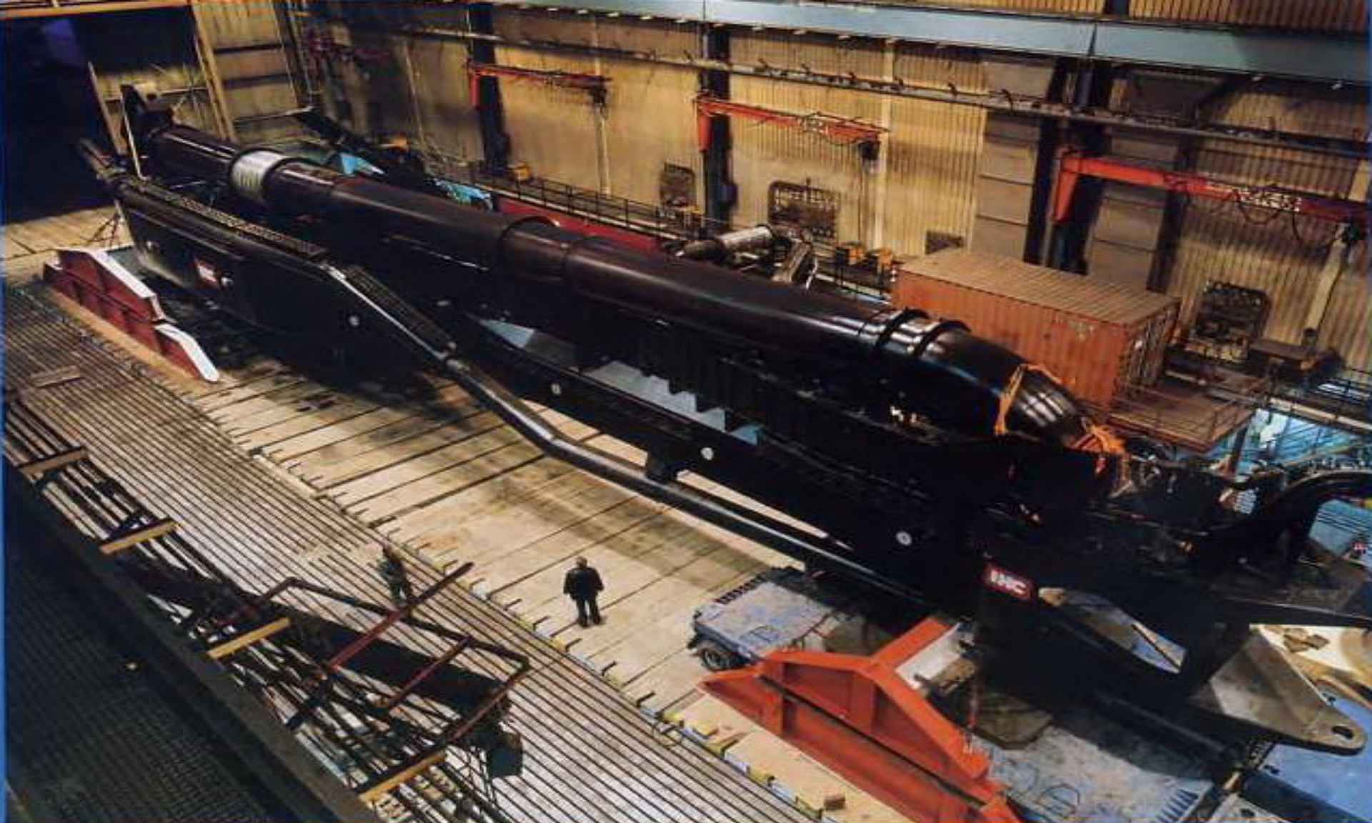
Pompe de l'élinde de la Vasco de Gama. Le tuyau d'aspiration fait 1400 mm de diamètre, la pompe fait 8700 cv, le tuyau du "jetwater" fait 600 mm de diamètre et une pression de 18 bars. Le poids de cet ensemble fait 320 tonnes.
