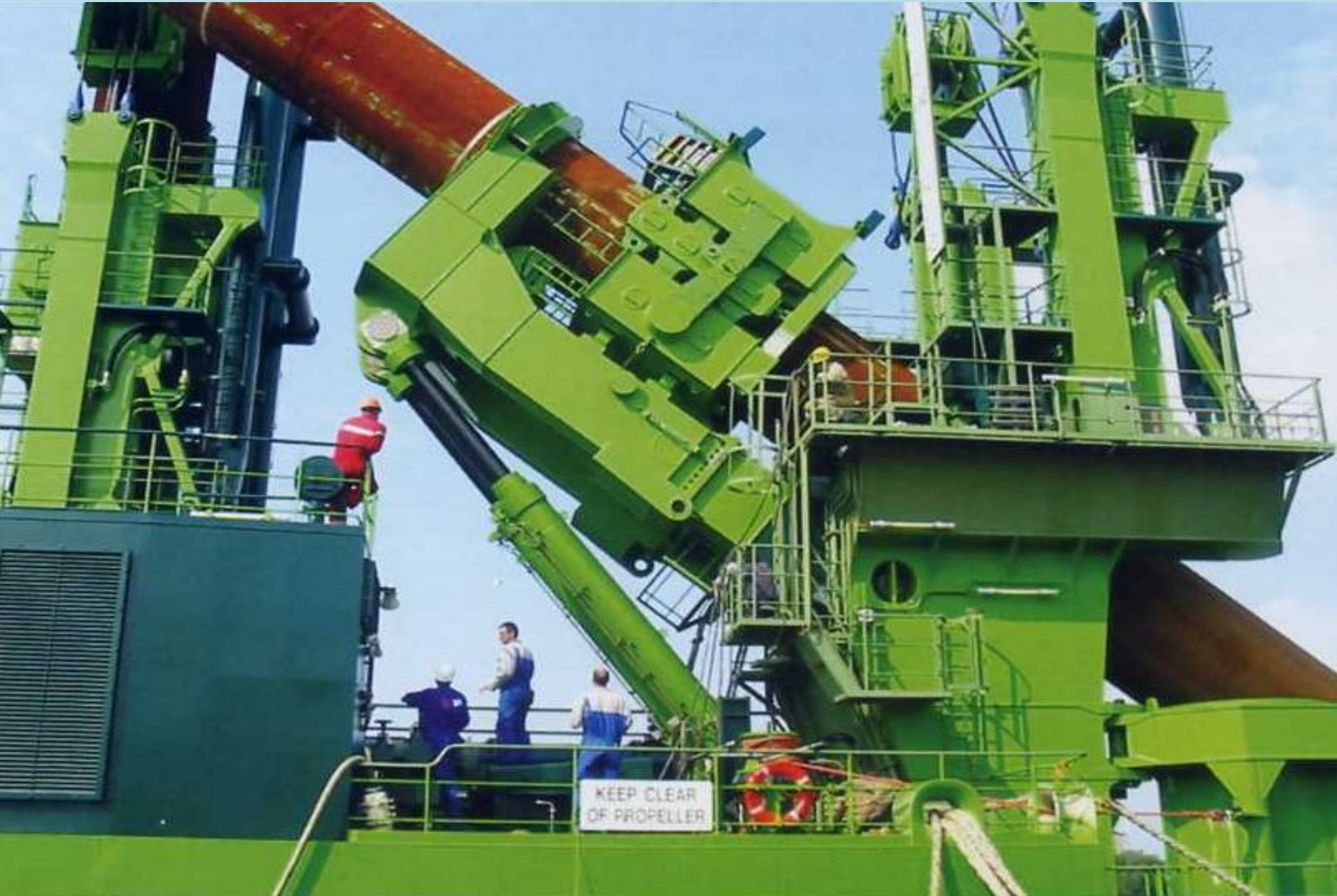
Drague à cutter Dartagnan manœuvrant ses pieux de dragage.
