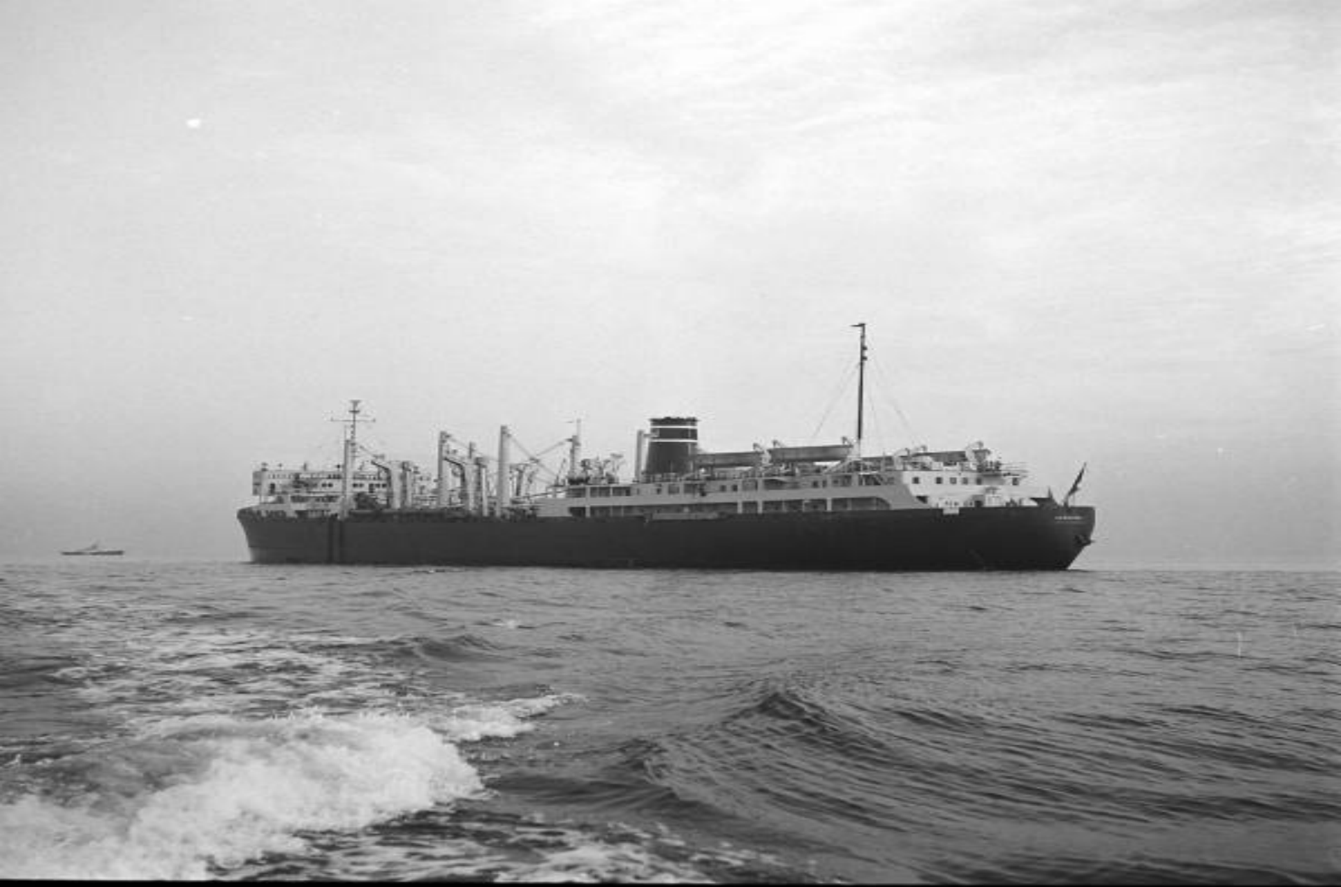
Une drague Américaine construite en 1959 à partir d'une coque de pétrolier. Elle mesurait 145 m de long pour un volume en puits de 3800 m 3
