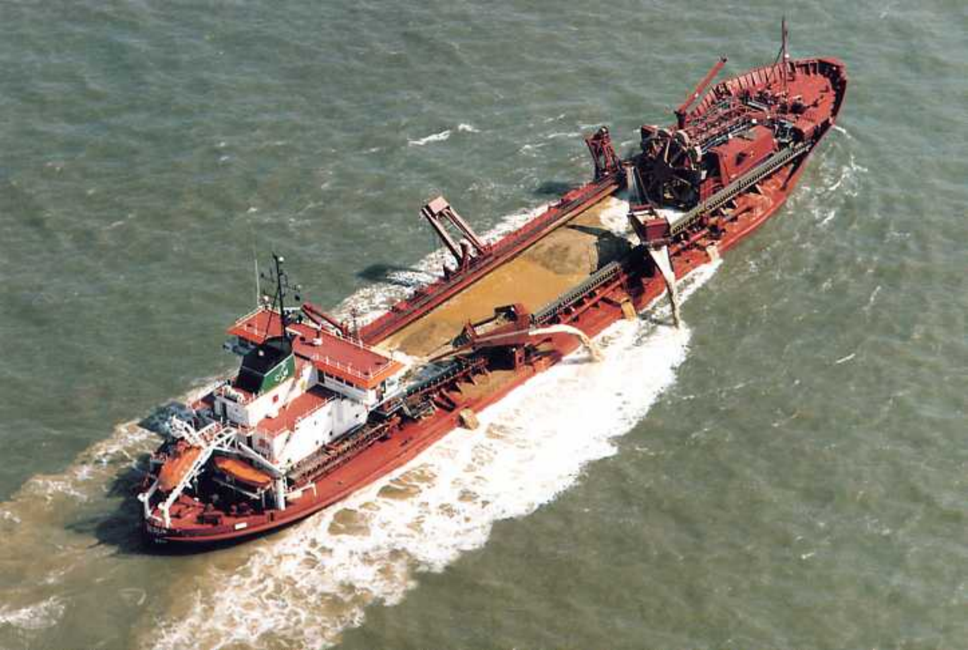
Drague de sables et graviers à déchargement sec
