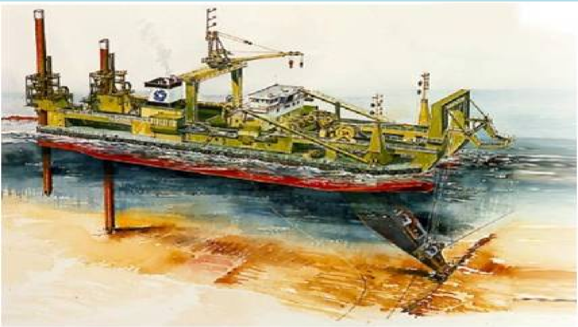
Vue d'une drague à cutter en dragage.
